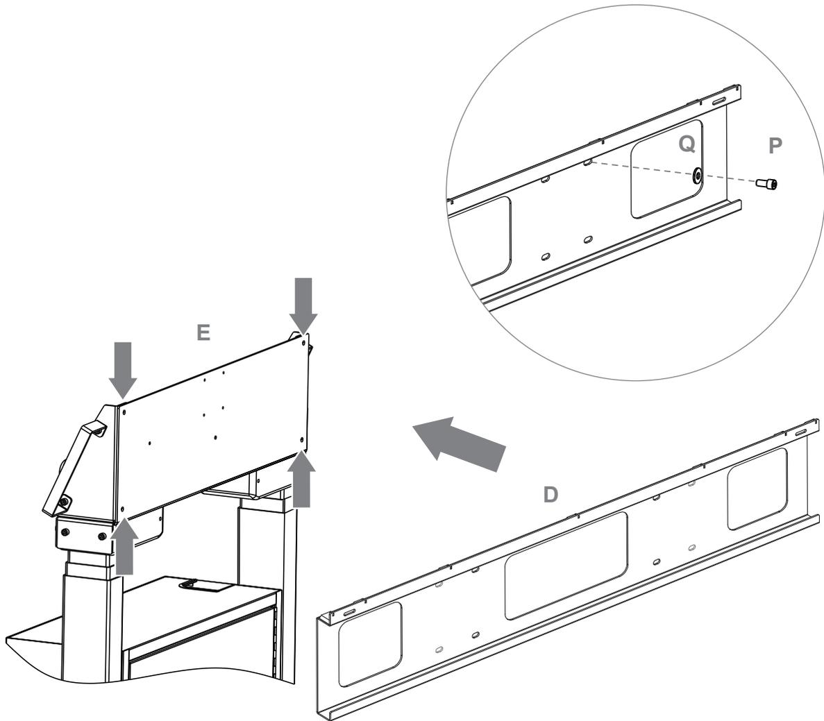
Verschrauben Sie die TV-Halterung an dem Kopf des Liftsystems. | Screw the TV bracket to the head of the lift system.
