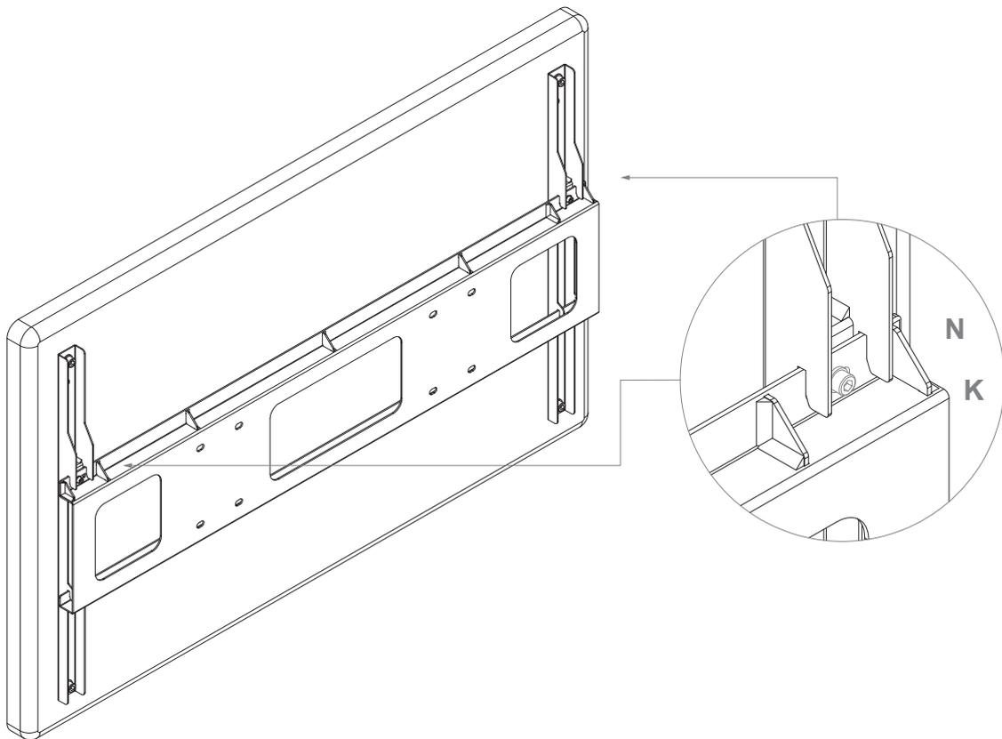
Sichern Sie den Bildschirm mittels Schraube und Unterlegscheibe auf beiden Seiten, wie in der Zeichnung angegeben.
