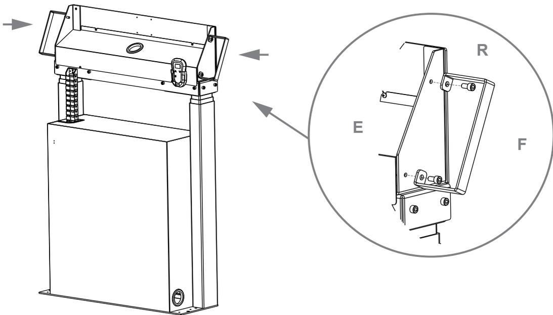
Verschrauben Sie die Griffe an der Seite des Lift-Systems | Screw the handles to the side of the lift system.
