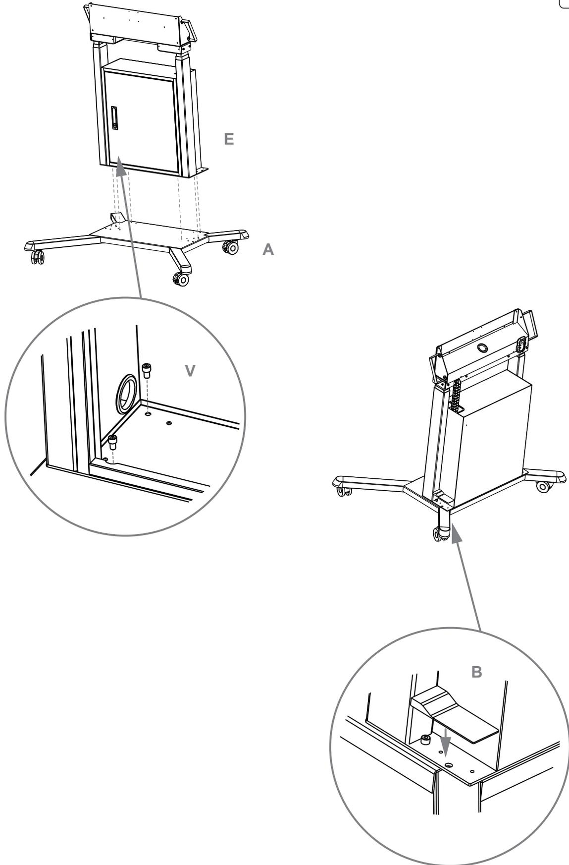
Verschrauben Sie das Liftsystem mit der mobilen Bodenplatte und setzen Sie die Abdeckung auf.
